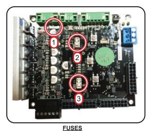
1) 24VDC 6.3A 2) 5VDC 3A 3) 12VDC 2A
